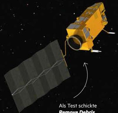
Als Test schickte **Remove Debris** Subsatelliten in den Orbit, um sie dann wieder zu fangen.
